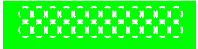
Bild 11: Wärmefalle (WF) auf den Innenlagen
