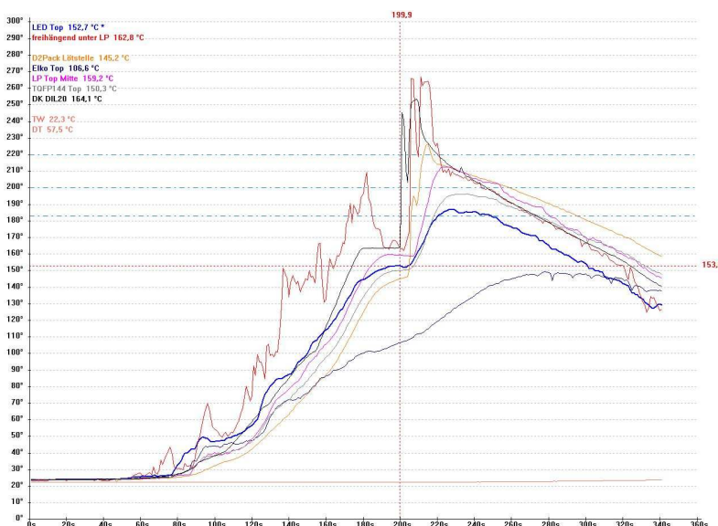
Bild 15: Wellen-Lötprofil für 12-Lagen ML, 2,4mm dick, 70µm Innenlagenkupfer
