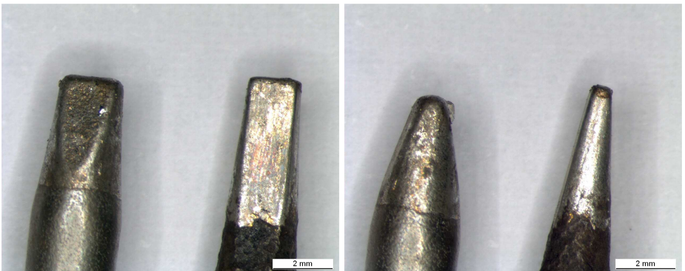
Bild 38: Lötspitzen: 2,0mm breit und stumpf, 1,6mm breit und spitz
