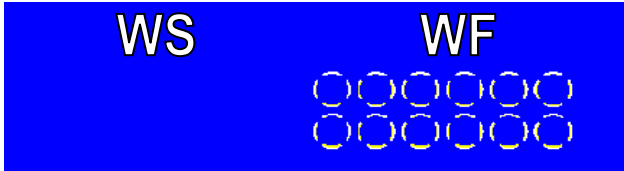
Bild 10: Wärmesenke und Wärmefalle auf Layer 6 bzw. 12
